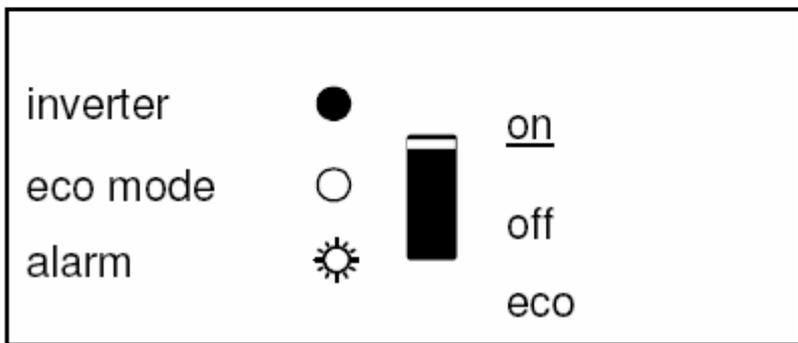
Инвертор включен и питает нагрузку. Предварительная тревога: перегрузки, или низкого напряжения батареи, или высокая температура
