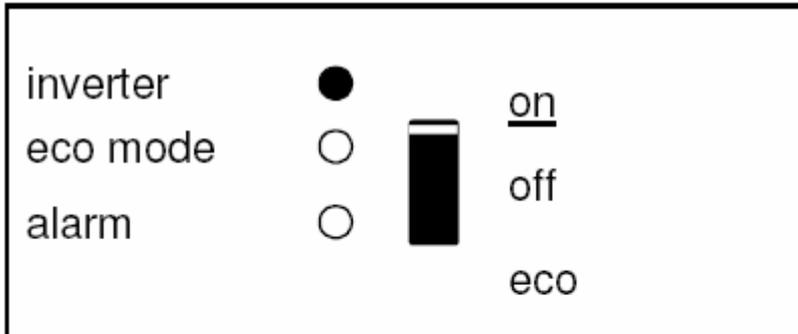
Инвертор включен и питает нагрузку. Работа от аккумулятора.
