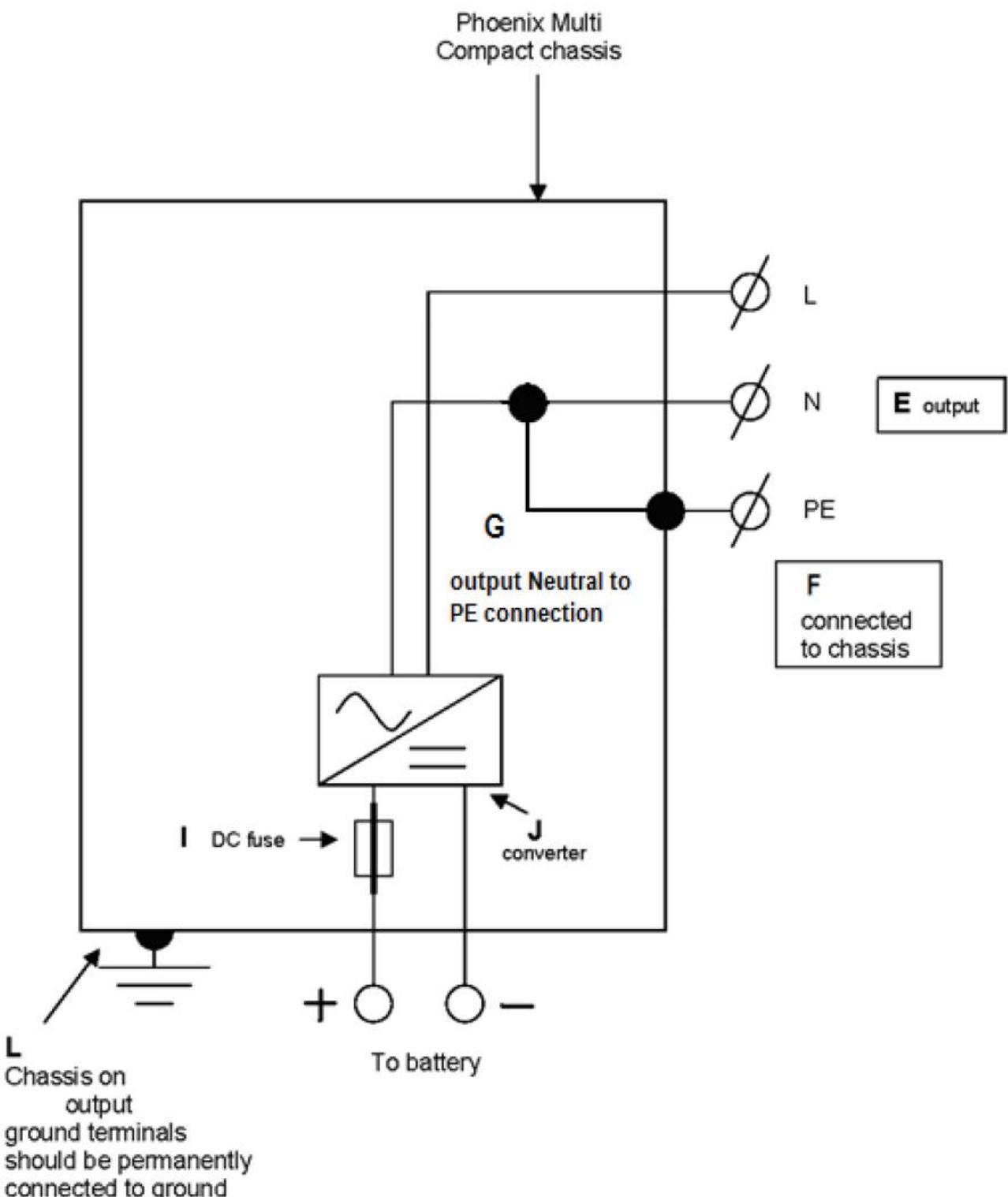
Этот провод заземления "G" соединяет выходной нейтральный провод к земле. Это, должно быть, удалено, если требуется
